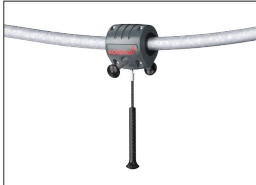
Die Aufhängevorrichtung ist mit einem geschweißtem Stahlkern und einem Gehäuse mit niedriger Dichte (PE) versehen. Die zwei gummibeschichteten Griffe sind angewinkelt, um die bestmögliche ergonomische Haltung zu haben, während man gleitet. Die Räder der Vorrichtung bestehen aus geräuscharmen TPU und werden mit installierten Kugellagern angebracht.
