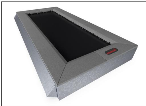
Tous les composants en acier sont fabriqués en acier au carbone S235 d'une épaisseur de 3 mm. Les panneaux latéraux, les murs de support pour le cadre supérieur, les plaques pliées avec SBR et les plaques plates pour le surfacage in situ sont galvanisés à chaud. Les deux longs panneaux latéraux sont électroingués et revêtus de poudre.
