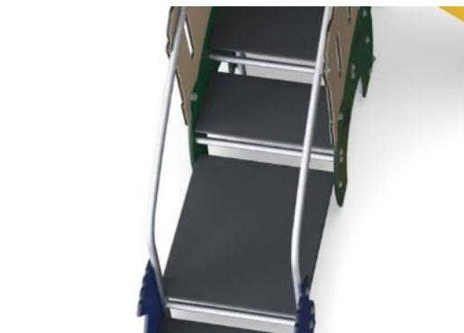
Tutti i pavimenti sono realizzati in laminato HPL ad alta pressione con spessore 17,8 mm e struttura superficiale antiscivolo secondo EN 438-6. KOMPAN HPL ha un'elevata resistenza all'usura per garantire una lunga durata in tutti i climi.
