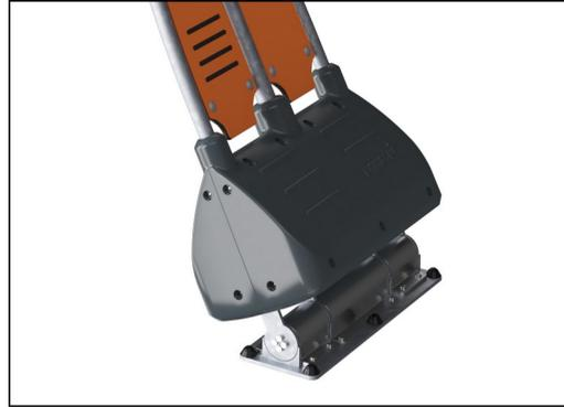
Le mouvement de bascule d'avant en arrière est contrôlé par un double ressort de torsion en caoutchouc à échelle robuste. L'élément en caoutchouc assure un mouvement sûr et réduit la vitesse vers les plateformes de la tour. Le couvercle de base est en PolyEthylène moulé à haute résistance aux chocs.
