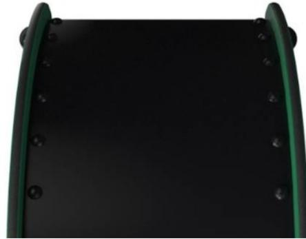
Membranen bestehen aus rutschfestem gummiertem Material in Förderbandqualität mit ausgezeichneter UV-Beständigkeit. Eingebettet ist eine vierlagige Armierung aus gewebtem Polyester. Die Armierung und die doppelte Oberflächenschicht ergeben eine Gesamtdicke von 9 mm.
