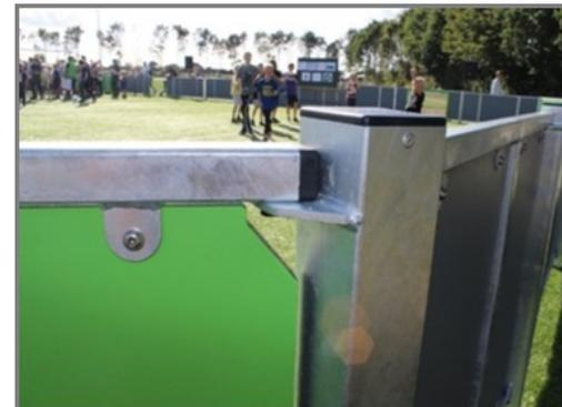
Die Polyethylen-Banden (HDPE) sind durch Edelstahlschrauben (M8 Gewinde) mit 42.5 x 40 x 3 mm großen, geschweißten Flanschen verbunden. Diese Verbindungen sind von innen nicht sichtbar und bilden eine stabile und sichere Verknüpfung.
