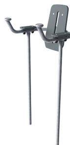
Der Rahmen der Leg Lift-Station ist aus einem HDG-Stahlrohr mit einem Durchmesser von 38 x 2 mm gefertigt. Die Stützplatten bestehen aus 15 mm Ekogrip®, einer 15 mm dicken PE-Platte mit einer 3 mm dicken Deckschicht aus thermoplastischem Gummi mit rutschfestem Effekt. Die Armstützen sind 110 x 195 mm gross, 580 mm voneinander entfernt und 1315 mm über dem Boden. Die Rückenstütze ist 335 x 500 mm gross. Die Aussparung in der Rückenstütze ist 30 x 350 mm gross.
