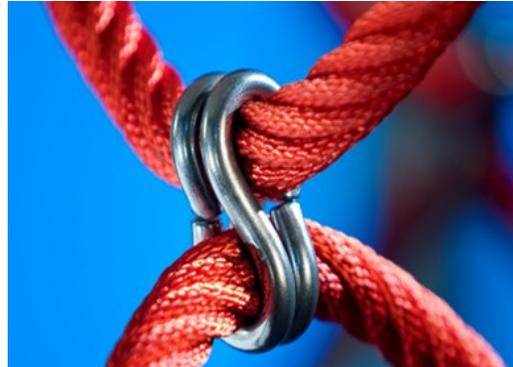
Corocord“S”扣在 Corocord 产品中作为通用连接。用特殊的液压机将带有圆形边缘的 8mm 不锈钢条压在绳索周围，使其成为理想的连接部件。其安全、耐用且防破坏，适用于攀爬网游戏中的典型游戏运动。
