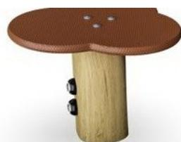
Die Stufen bestehen aus 21,5 mm dicken Siebträger Platten aus Erlen- und Kiefernholz. Beide Seiten sind mit 2 Lagen Phenolfilm mit Antirutsch-Beschichtung bedeckt. Alle Schnittkanten sind mit Farbe versiegelt, um eine lange Lebensdauer zu gewährleisten.
