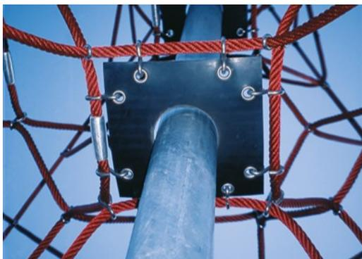
Membrány Corocord jsou vyrobeny z oděruvzdorného pogumovaného materiálu v kvalitě používané u pásových přepravníků a mají vynikající odolnost vůči UV záření. Jsou testovány a splňují nařízení REACH pro polycyklické aromatické uhlovodíky (PAH). Je do nich integrováno čtyřvrstvé vyztužení ze tkaného polyesteru. S tímto vyztužením a dvěma povrchovými vrstvami mají celkovou tloušťku 7,5 mm.
