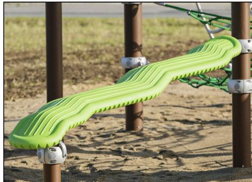
Der Wackelbalken besteht aus PE mittlerer Dichte mit hervorragender Schlagzähigkeit und ist für einen großen Temperaturbereich geeignet. Die hohlen Kunststoffteile bestehen aus 100% recycelbarem PE, das zu 33% aus Post-Consumer-Materialien hergestellt wird. Geformt in einem Stück mit einer Wandstärke von mindestens 5 mm. Die Längsrillen bieten eine rutschfeste Oberfläche für sicheres Spielen.
