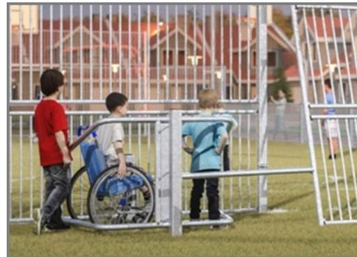
La entrada para silla de ruedas está construida con un poste de 80 x 80 x 3 mm con tubo de Ø 48 mm y 2 bisagras de acero inoxidable de 16 mm. La apertura es de 95 cm de ancho y 112 cm de largo, esto permitirá que las personas en silla de ruedas ingresen al MUGA pero detendrán los ciclomotores y motores.
