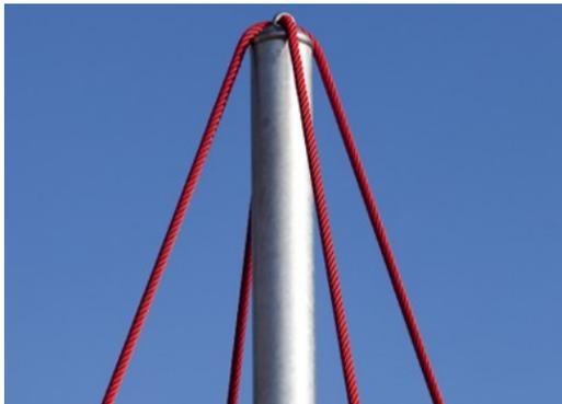
Im Zentrum des Raumnetzes befindet sich der Mast, bestehend aus hochwertigem, nahtlosem Stahl. Die Maststruktur ist als Pendelstütze statisch besonders günstig und gleicht die Schwingungen im Raumnetz aus. Die Masten sind serienmässig feuerverzinkt, eine zusätzliche Pulverbeschichtung ist optional erhältlich.
