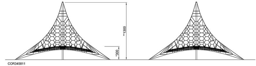
Attention! Les blocs d'ancrage dépassent la zone de sécurité. Voir les instructions d'installation.
