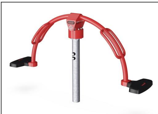
Le parti metalliche sono realizzate in acciaio di alta qualità, zincato a caldo internamente ed esternamente con zinco senza piombo. Sulla parte superiore è presente un ulteriore strato di verniciatura a polvere. Ciò garantisce sia un'eccellente resistenza alla corrosione che un'espressione di design colorato.
