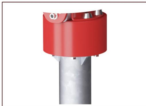
Sistema di cuscinetti ingegnerizzato per impieghi gravosi con due cuscinetti a sfere a una corona di scanalature profonde di alta qualità con guarnizioni in gomma. La struttura del cuscinetto completamente chiusa è lubrificata a vita.
