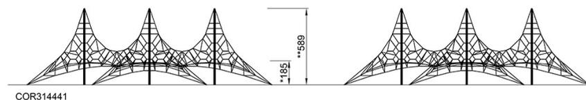
Attention! Les blocs d'ancrage dépassent la zone de sécurité. Voir les instructions d'installation.
