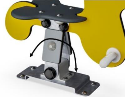
Die Wippbewegung über Achse wird durch ein hochbelastbares, skaliertes ROSTA-Torsionsfederelement ausgeführt. Das ROSTA-Element arbeitet geräuschlos und ist wartungsarm.
