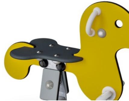
Der Sitz besteht aus HPL (Stärke 17,8 mm) und besitzt eine hohe Verschleißfestigkeit und eine spezielle Anti-Rutsch-Oberflächenstruktur.
