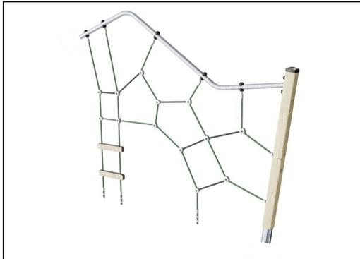
Corocord-Seile aus UV-stabilisierten PES-Seilsträngen mit innerer Stahlseilverstärkung. Das Polyestergerüst wird aus +95 % Post-Consumer-Materialien hergestellt und induktiv auf jede Litze aufgeschmolzen. PES hat eine hohe Festigkeit mit ausgezeichneter Beständigkeit gegen Abrieb und UV-Strahlung. Die Seile sind mit S-Klemmen aus Edelstahl verbunden.
