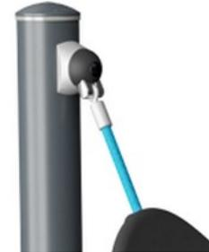
Die einzigartigen KOMPAN Drehaufhängungen ermöglichen sowohl Schwing- als auch Schaukelbewegungen der Hängematte. Das Gehäuse innen besteht aus rostfreiem Edelstahl und sowohl die Buchsen- als auch die Lagerstange bestehen aus einer Messinglegierung. Die Außenabdeckung besteht aus weichem TPE Gummi und das gesamte Drehgelenk ist mit dem Stahlpfosten durch einen Aluminiumstecker verbunden.
