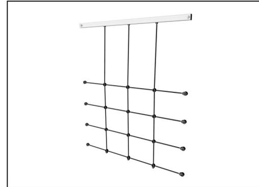
Les filets d'escalade sont fabriqués en corde PA avec stabilisation UV et renforcement intérieur par câblage en acier. La corde est traitée par induction afin d'obtenir une fixation optimale entre l'acier et la corde, offrant ainsi une excellente résistance à l'usure. Tous les connecteurs de corde sont fabriqués en matériaux PA 100 % recyclables.
