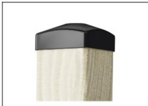
Las tapas de los extremos de los postes están hechas de nylon de alta calidad (PA6) moldeado por inyección. El PA6 tiene una buena resistencia al desgaste y al impacto y está estabilizado a los rayos UV. Las tapas de los extremos protegen los postes colocados verticalmente para garantizar una larga vida útil.
