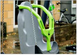
Le harnais est réalisé en polyéthylène (PE) recyclable moulé, fabriqué avec 33 % de matériaux post-consommation. Le harnais utilise un ressort de torsion en acier inoxydable qui lui permet de rester dans toutes les positions pour faciliter la montée et la descente des utilisateurs. Le verrou du harnais est conçu avec une pièce coulissante en acier inoxydable qui s'opère d'une seule main.
