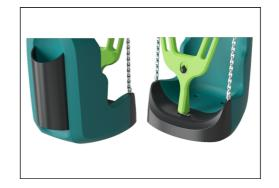
L'amortisseur avant est composé d'un noyau en polypropylène (PP) résistant avec une couche extérieure plus souple en caoutchouc thermoplastique (TPE), tandis que l'amortisseur arrière est doté d'une membrane en caoutchouc EPDM de 8 mm d'épaisseur. Les amortisseurs souples absorbent les chocs, sont dotés d'une surface antidérapante et permettent ainsi une utilisation sécurisée du siège de
