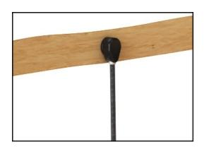
Corde costituite da trefoli in PES stabilizzati ai raggi UV con rinforzo interno in cavo d'acciaio. Il filato di poliestere è composto per il +95% da materiali post-consumo e viene fuso induttivamente su ogni trefolo per ottenere un'eccellente resistenza all'usura.
