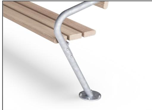
Die Stahloberflächen sind innen und außen mit bleifreiem Zink feuerverzinkt. Die Verzinkung hat eine ausgezeichnete Korrosionsbeständigkeit in Außenumgebungen und ist wartungsarm. Lackierte Stahlbestandteile werden vor der Pulverbeschichtung feuerverzinkt.
