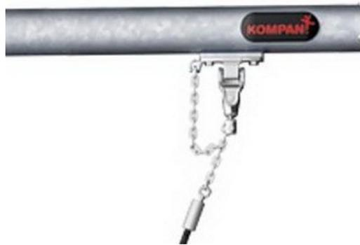
KOMPAN Schwerlast-Schaukelaufhängungen aus rostfreiem Stahl mit Verdrehsicherung. Die Aufhängungen sind mit zwei Bolzen am Querträger auf einer geschweissten Halterung befestigt. Die Lager sind mit Silikonschmiermittel versehen und benötigen keine weitere Schmierung.
