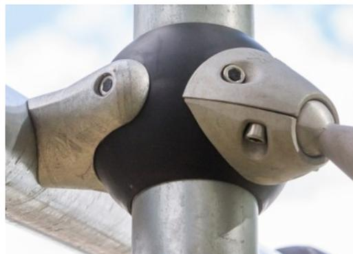
La bola de conexión GALAXY, de diseño exclusivo está hecha con un núcleo circular interno de aluminio rodeado por una carcasa de PP duro con una capa externa de caucho TPV suave. Los conectores flexibles de aluminio sin plomo permiten la instalación en ángulos variables.
