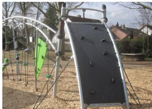
El muro de escalada curvo está hecho de un panel Ekogrip® con marco de acero con tacos de escalada de diseño único. El panel Ekogrip® consta de una base de PE de 15mm de espesor con una capa superior de goma de 3 mm con efecto antideslizante.
