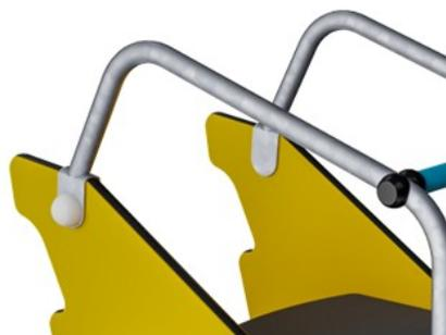
Les poteaux sont fabriqués à partir d'acier galvanisé à chaud à l'intérieur et à l'extérieur, avec du zinc sans plomb. La galvanisation présente une excellente résistance à la corrosion en milieu extérieur et ne nécessite que peu d'entretien.
