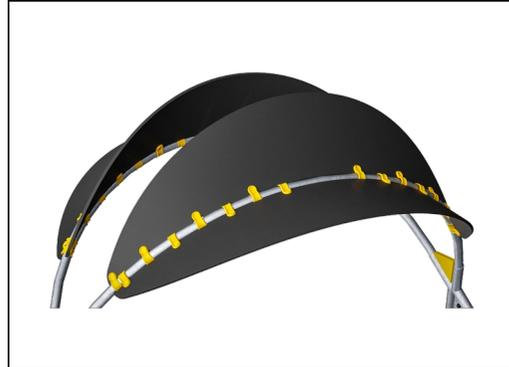
Le toit est constitué d'un panneau Ekogrip® supporté par un cadre en acier. Le panneau Ekogrip® se compose d'une base en PE de 15 mm d'épaisseur avec une couche supérieure de caoutchouc de 3 mm.
