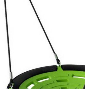
贝壳座椅由 100 % 可回收聚乙烯 (PE) 制成, 并滚塑成型为一件。座椅设计有较大的外部开口便于抓握, 中间的孔用于排出水和污垢。四根绳索均附有热浸镀锌钢支架, 以确保多年的耐用性。
