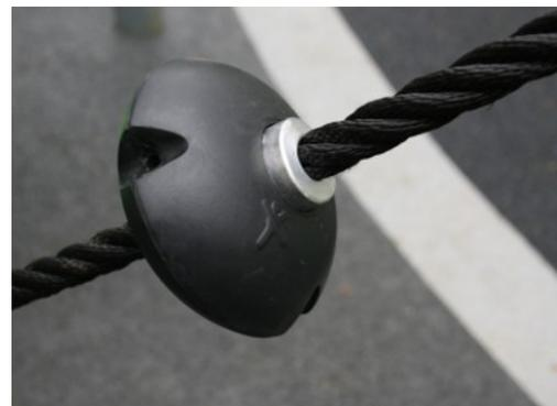
Les cordes sont constituées de torons PES (Polyéthersulfone) stabilisés aux UV avec un renfort interne en acier. L'emballage en polyester est fondu par induction sur chaque brin pour obtenir une excellente résistance à l'usure et à la déchirure.
