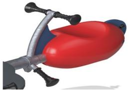
Les poignées et les repose-pieds sont fabriqués avec un insert polypropylène (PP) moulé et une couche extérieure de caoutchouc TPV souple. Les poignées et les repose-pieds sont fixés au tuyau avec un renfort interne en acier galvanisé afin d'assurer à la fois résistance et durabilité.
