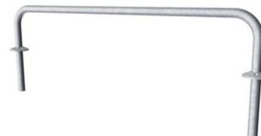
I corrimani intesi come impugnature durante gli esercizi sono realizzati in acciaio zincato a caldo da 38 mm, un grande diametro per una buona presa e per sostenere il polso. L'altezza del corrimano è 940 mm dalla parte superiore della piastra HPL. La distanza tra le rotaie è di 900 mm.
