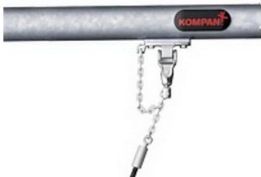
KOMPAN Schwerlast-Schaukelabhängungen aus rostfreiem Stahl mit Verdrehsicherung. Die Aufhängungen sind mit zwei Bolzen am Querträger auf einer geschweißten Halterung befestigt. Die Lager sind mit Silikonschmiermittel versehen und benötigen keine weitere Schmierung.
