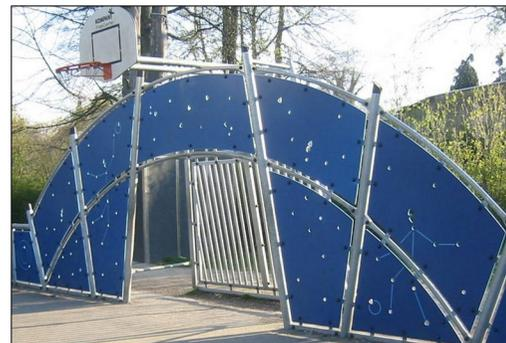
Le porte misurano circa 140 cm in profondità e circa 330 cm in larghezza, con tutti i pali realizzati in acciaio zincato con trattamento superficiale zincato a caldo. Il telaio anteriore è realizzato con tubi Ø48, mentre il retro della porta utilizza 10 tubi con un diametro di Ø38.
