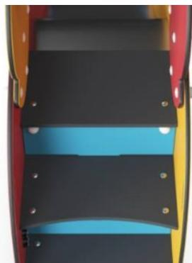
Les marches sont fabriquées en stratifié haute pression HPL, d'une épaisseur 17,8 mm et la texture de surface antidérapante respectant la norme EN 438-6. KOMPAN HPL présente une grande résistance à l'usure, ce qui lui assure une longue durée de vie quel que soit le climat.
