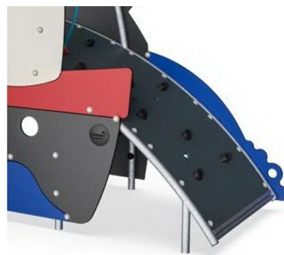
La parete da arrampicata curva è realizzata con pannello EkoGrip costituito da una base in polietilene (PE) di 15 mm di spessore con uno strato superiore di 3 mm di gomma morbida con effetto antiscivolo.
