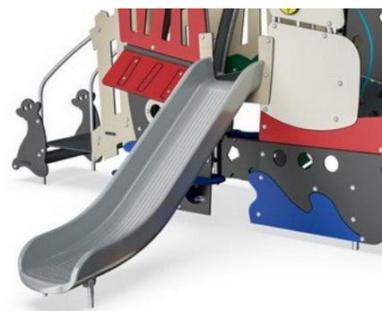
Lo scivolo è realizzato in polietilene (PE) stampato. Il PE ha un'elevata resistenza agli urti su un ampio intervallo di temperatura che garantisce resistenza agli atti vandalici in tutti i luoghi.
