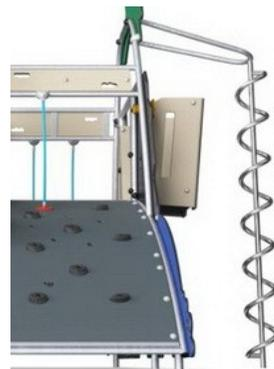
Le parti in acciaio sono realizzate con acciaio inossidabile di alta qualità. L'acciaio viene pulito con un processo di decapaggio totale dopo la produzione per garantire superfici di scorrimento lisce e pulite.
