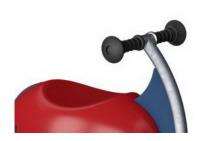
Les poignées sont fabriquées d'un insert PP moulé et recouvert de caoutchouc TPV souple. La poignée est fixée au tube avec un renfort interne en acier galvanisé afin d'assurer à la fois résistance et longévité.
