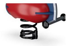
Les ressorts KOMPAN sont fabriqués en acier de haute qualité selon la norme EN 10270. Les ressorts sont nettoyés par phosphatation, avant d'être peints avec une amorce époxy et un revêtement thermolaqué de polyester en guise de finition. Les ressorts sont fixés par des raccords anti-pincement uniques pour une sécurité maximale et une longue durée de vie.
