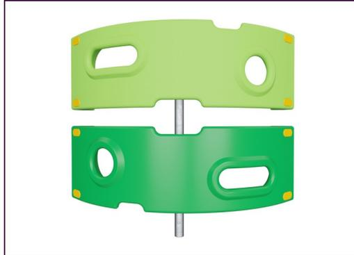
Die dargestellten Kletterelemente sind in einem Stück formgepresst, bestehen aus 33 % recyceltem Post-Consumer-Material und besitzen eine Mindestandstärke von 5 mm. Die Kletterelemente sind aus recycelbarem PE mit einer hohen Verschleissfestigkeit und Temperaturbeständigkeit gefertigt. So sind sie äusserst vandalismusbeständig in allen Aussenumgebungen.
