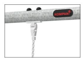
KOMPAN 设计的重载型不锈钢秋干吊架具有防扭 亲子秋千座椅配有 6 毫米不锈钢链。 曲功能。吊架通过两个螺栓固定在焊接支架上的 横梁上。轴承内嵌硅酮润滑剂, 无需进一步润滑。
