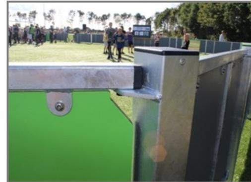
Los paneles de HDPE están conectados con pernos de acero inoxidable M8 a bridas soldadas de 42.5 x 40 x 3 mm. Estas conexiones no son visibles desde el interior y crean una conexión fuerte y segura.
