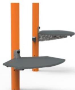
La plaque supérieure de la plateforme de saut est composée de panneaux Ekogrip®, qui se composent d'une couche inférieure en polyéthylène de 15 mm, avec une couche supérieure en caoutchouc thermoplastique de 3 mm offrant un effet antidérapant pour des exercices de saut en toute sécurité, quelles que soient les conditions météorologiques.
