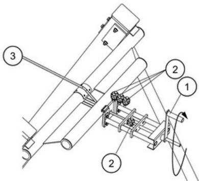
钢缆 3 通过特殊设计的装置张紧。通过旋转手柄 1，可以按照说明以安全的方式拉紧钢缆。张紧后，电缆将被三个夹子 2 锁定。张紧装置还可在年度检查期间用于调节。
