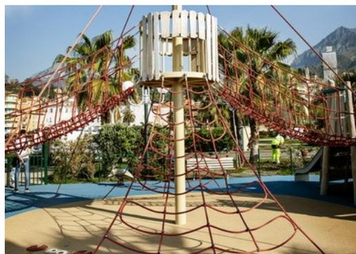
Corocord 16 mm Seile aus UV-stabilisierten PES-Litzen mit innerer Stahlseilverstärkung. Das Polyestergerüst besteht aus +95% Post-Consumer-Materialien und wird induktiv auf jede Litze aufgeschmolzen. Damit sind die Seile besonders beständig gegenüber Abnutzung und Vandalismus. Corocord-Seile können jederzeit vor Ort ausgetauscht werden.
