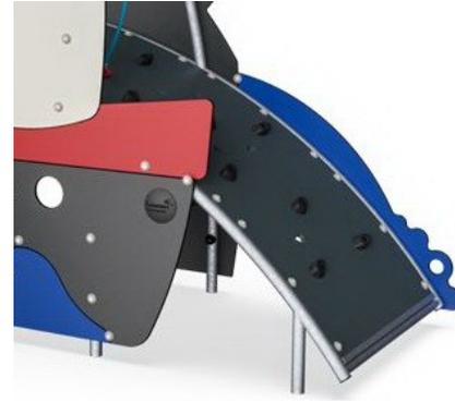
Le mur d'escalade incurvé est fabriqué à partir d'un panneau Ekogrip® qui se compose d'une base de PE de 15 mm d'épaisseur avec une couche de 3 mm de caoutchouc souple pour un effet antidérapant.
