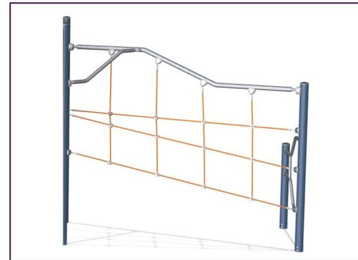
Les cordes ELEMENTS sont munies de toron d'acier à six brins et d'un cœur en câble d'acier. Chaque toron est enveloppé hermétiquement dans du fil en PES. Une fois que le frottement initial a enlevé les fibres de surface, un revêtement plus dur de PES reste pour protéger chaque brin, garantissant une excellente résistance à l'usure et au vandalisme.
