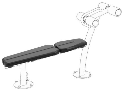
El asiento y el respaldo están hechos de Caucho de Poliuretano (PUR) y tienen una placa de inserción de acero electrogalvanizado que conecta el asiento a la estructura de acero. El asiento y el respaldo están colocados en un ángulo de 8 grados para una correcta ergonomía. El respaldo tiene una ranura para aliviar la columna vertebral, acomodando una posición cómoda para sentarse, otro beneficio es que drena el agua fácilmente.
