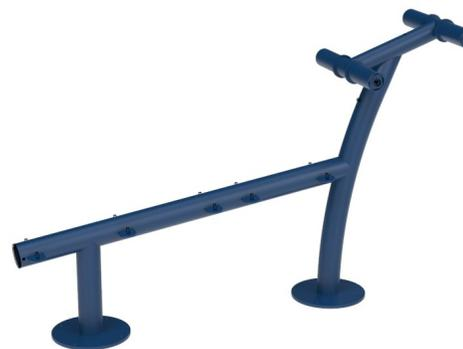
Todos los componentes de acero están hechos de acero al carbono, con una superficie galvanizada en caliente según ISO1461 y una clase de corrosión C3 de pintura en polvo según ISO12944-2. El contenido de plomo para las superficies es inferior a 90 ppm y inferior a 100 ppm para el material base.
