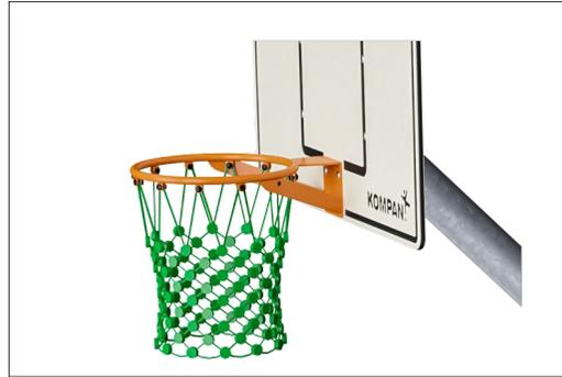
Il canestro da basket è realizzato in acciaio zincato a caldo con finitura in polvere. La rete è realizzata con corda PA KOMPAN Ø5 rinforzata con filo d'acciaio. La rete ha una circonferenza di circa Ø30 cm nella parte inferiore e Ø50 cm nella parte superiore.
