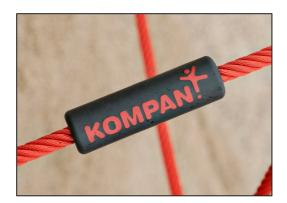
Seile aus UV-stabilisierten PES-Litzen mit innerer Stahlseilverstärkung. Das Polyestergarn besteht aus +95% Post-Consumer-Materialien und wird induktiv auf jede Litze aufgeschmolzen. Damit sind die Seile besonders beständig gegenüber Abnutzung und Vandalismus und können jederzeit vor Ort ausgetauscht werden.
