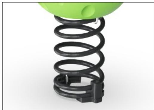
Les ressorts KOMPAN sont fabriqués en acier de haute qualité selon la norme EN 10270. Les ressorts sont nettoyés par phosphatation, avant d'être peints avec une amorce époxy et un revêtement thermolaqué de polyester en guise de finition. Les ressorts sont fixés par des raccords anti-pincement uniques pour une sécurité maximale et une longue durée de vie.
