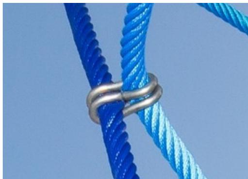
I morsetti a "S" di Corocord sono utilizzati come connessioni universali nei prodotti Corocord. Le aste in acciaio inossidabile da 8 mm con bordi arrotondati sono pressate attorno alle corde con una speciale pressa idraulica, rendendole il connettore ideale: sicuro, durevole e antivandalismo, il tutto pur consentendo il tipico movimento delle strutture di gioco della corda.
